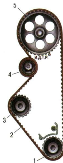
Рис. 2.12. Цепной привод ГРМ: 1 - зубчатый шкив привода распределительного вала; 2 - цепь; 3 - успокоитель цепи; 4 - зубчатый шкив привода масляного насоса; 5 - зубчатый шкив коленчатого вала; 6 - башмак натяжителя цепи; 7 - натяжитель цепи
