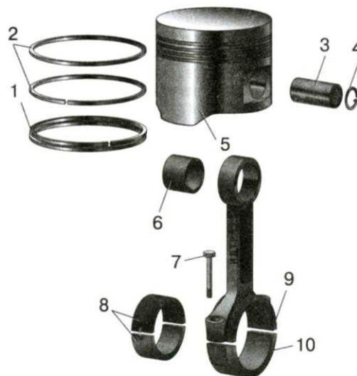
Рис. 2.4. Поршень: 1 - маслосъемное кольцо; 2 - компрессионные кольца; 3 - поршневой палец; 4 - стопорное кольцо; 5 - юбка поршня; 6 - втулка; 7 - болт; 8 - вкладыши; 9 - шатун; 10 - крышка шатуна
