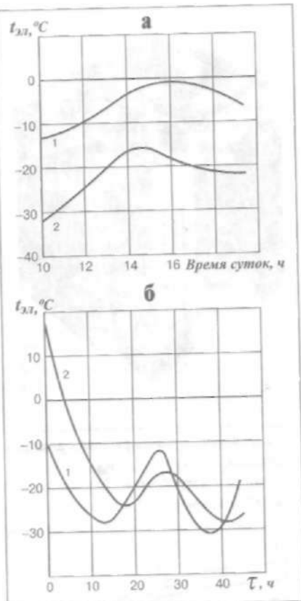
Рис. 2.41. Изменение температуры электролита t_{эл} неутепленной аккумуляторной батареи: а – при движении автомобиля; б – при стоянке автомобиля; 1 – температура окружающего воздуха; 2 – температура электролита
