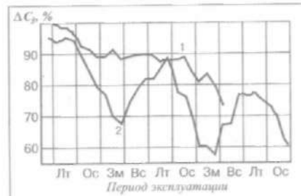
Рис. 2.46. Изменение средней степени заряженности батареи \Delta C_3 в течение эксплуатации автомобиля (Лт – лето; Ос – осень; Зм – зима; Вс – весна): 1 – 6СТ-60 на автомобиле ГАЗ-24 (такси); 2 – 6СТ-90 на автомобиле ЗИЛ-130
