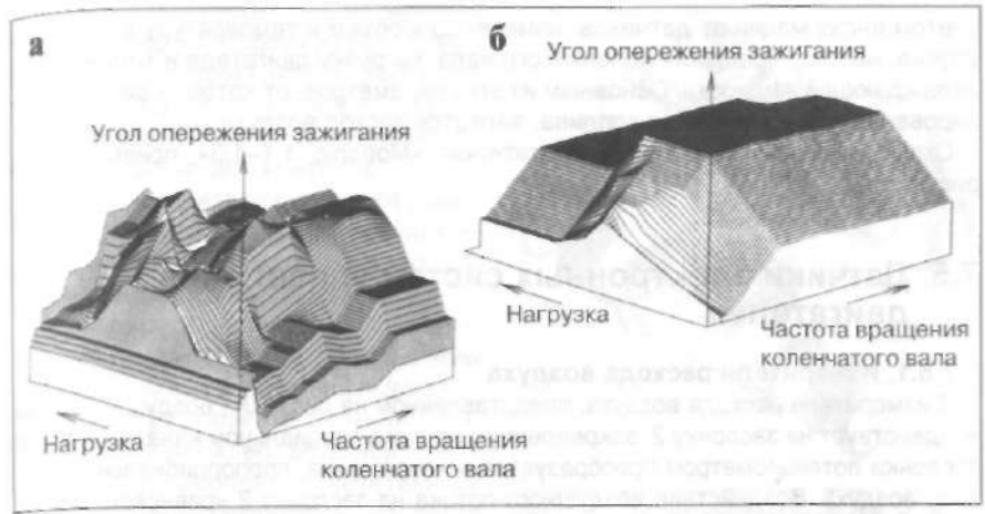
Рис. 7.29. Диаграммы углов опережения зажигания для различных систем управления: а – микропроцессорной системы зажигания; б – системы с центробежно-вакуумным автоматом
