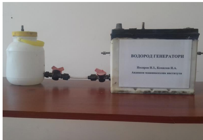
27- rasm. YAsalgan elektrolizyorning yonidan ko'rinishi
