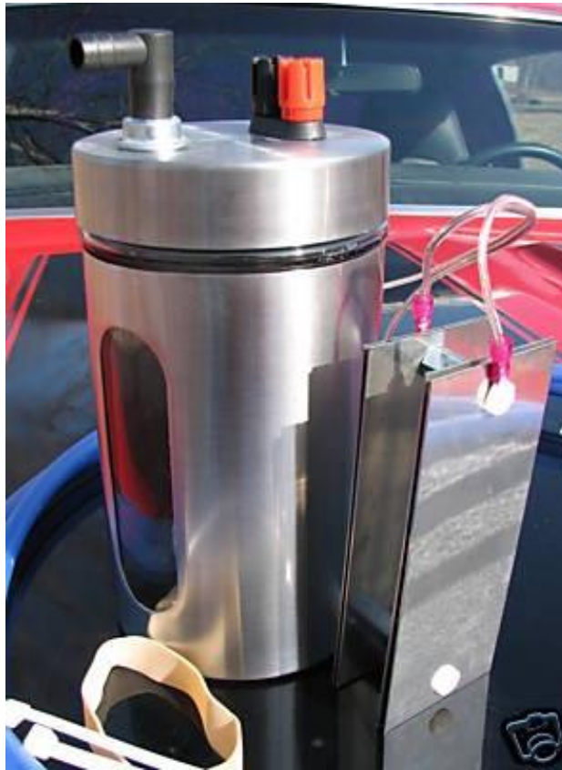
9- rasm. «Katerpillar», «Kammins» firmalari (AQSH)da ishlab chiqarilayotgan suv gazi generatori
