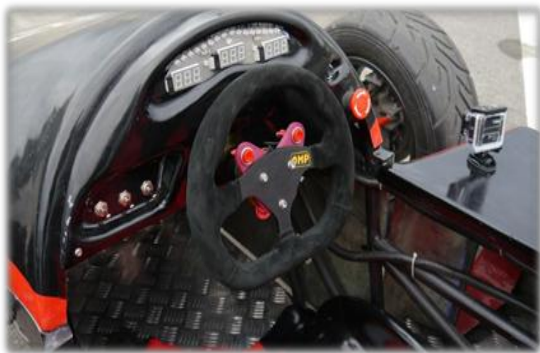
7-расм. Формула болиди учун қўйилган тайёр йигма панел ҳолати
