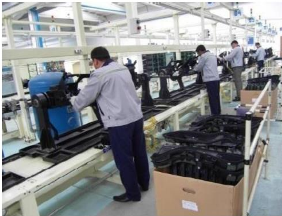
2.8-rasm. Instrumentlar paneli va eshik qoplamalarni yig‘ish jarayoni
