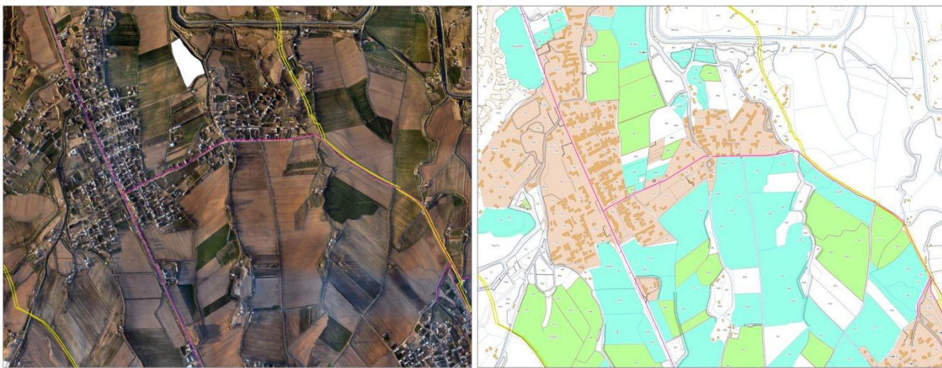
1-расм. Қашқадарё вилояти Чироқчи тумани Пахтакор ҳудуди учувчисиз учиш аппаратлари ёрдамида суратга олиш натижаларини юқорида айтиб ўтилган тизим асосида таҳлил қилинган кўриниши.
