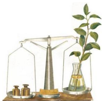
14 – rasm. Transpiratsiya jadalligini tarozida tortish yo'li bilan aniqlash
