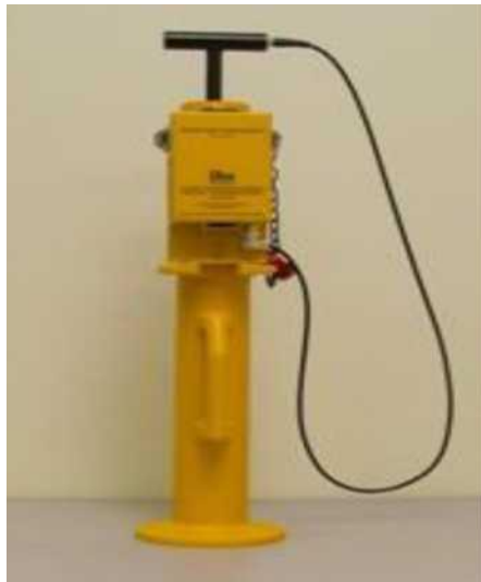
22- расм: “CLEGG IMPACT SOIL TESTER CIST/883” қурилмасининг қурилиши. а) умумий қурилиши б) схематик қурилиши,
