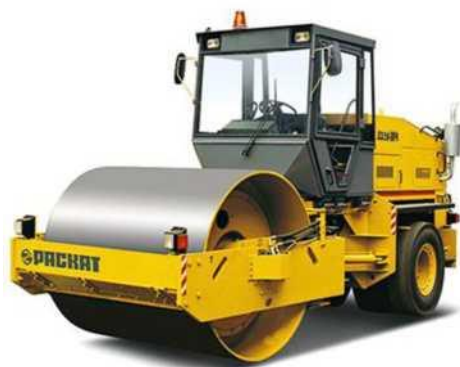
46- расм. Хозирги замон йўл қатламларни зичлаш катоклари: а) аралаш турдаги вибро каток; б) ковурғали каток.
