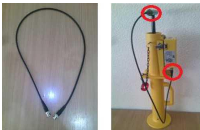
Расм 5.7. Стандарт CLEGG болҒаси зарб микдорини улчагичга узатувчи кабел
