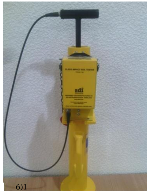
Расм 5.1. “CLEGG IMPACT SOIL TESTER CIST/883” курилмасининг куруниши. а) схематик куруниши, б) умумий куруниши
