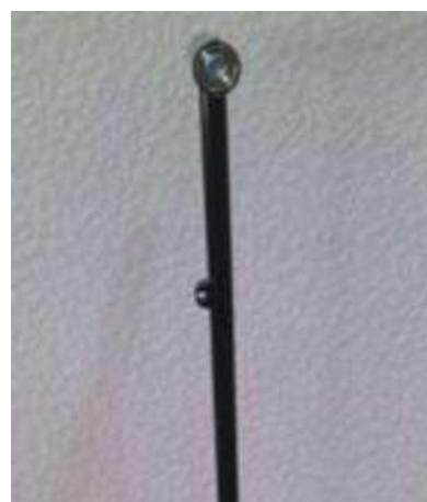
Расм 5.3. а) стандарт CLEGG болҒаси ушлагичи; б)таврсимон дастаги
