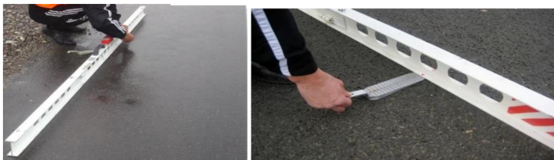
86-расм: Равонликни уч метрли река ёрдамида аниклаш.
