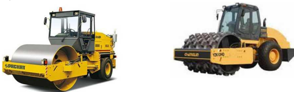
15- расм. Хозирги замон йўл қатламларни зичлаш катоклари: а) аралаш турдаги вибро каток; б) цовурғали каток
