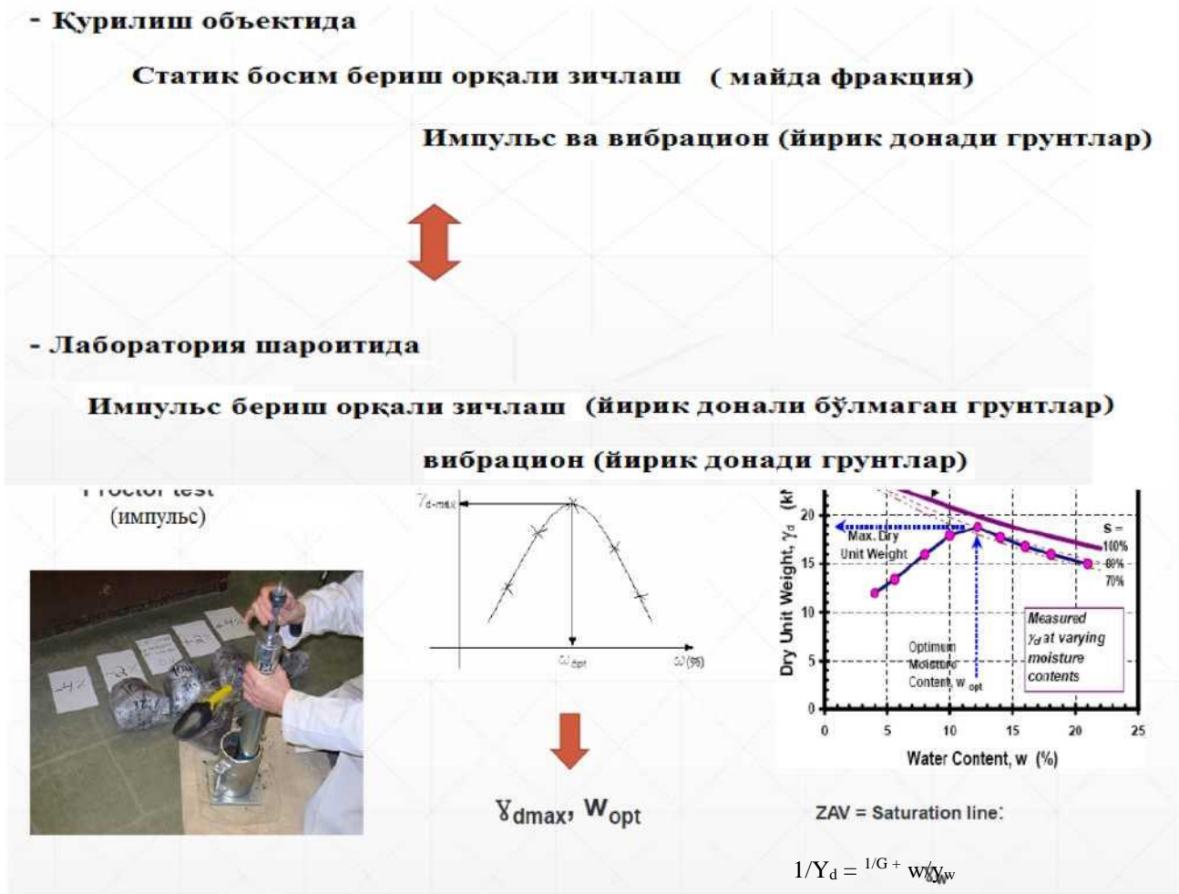
9-расм: БоФланган грунтларни лаборатория шароитида зичлаш.
