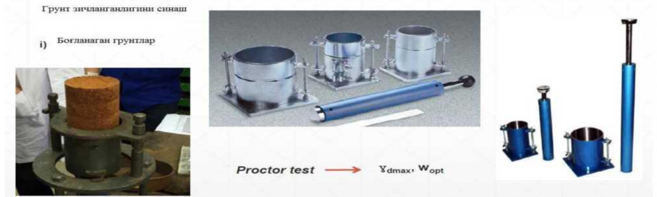
19-расм: Олинган намунани дала шароитида зичлик даражасини аниқлаш
