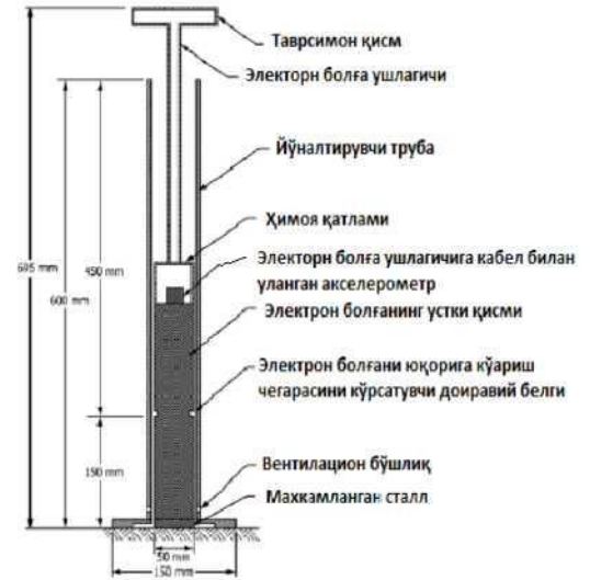
22- расм: “CLEGG IMPACT SOIL TESTER CIST/883” қурилмасининг қурилиши. а) умумий қурилиши б) схематик қурилиши,
