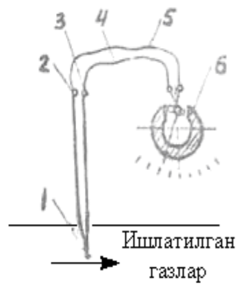
8-Rasm. Termoelektrik termometrni sxemasi
