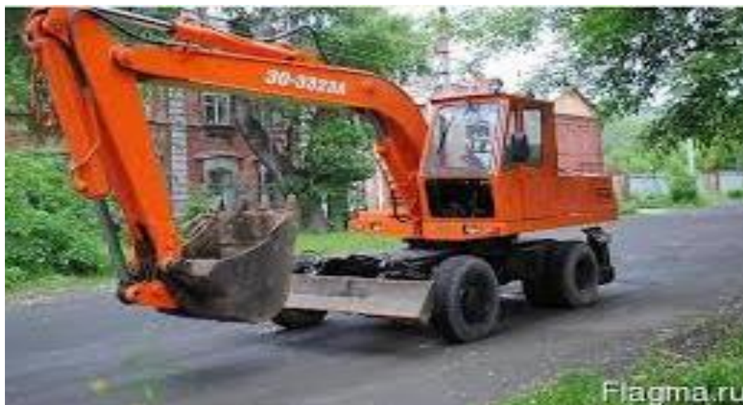
4.1- расм. Бир чўмичли пневмошинали экскаватор.
