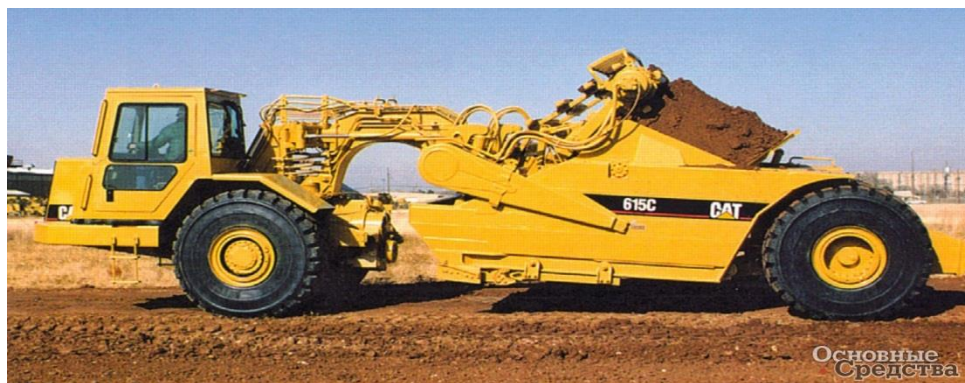
6.2-расм. CATERPILLER CAT 615C русумли бир ўкли ўзи юрар элеваторли скрепер.
