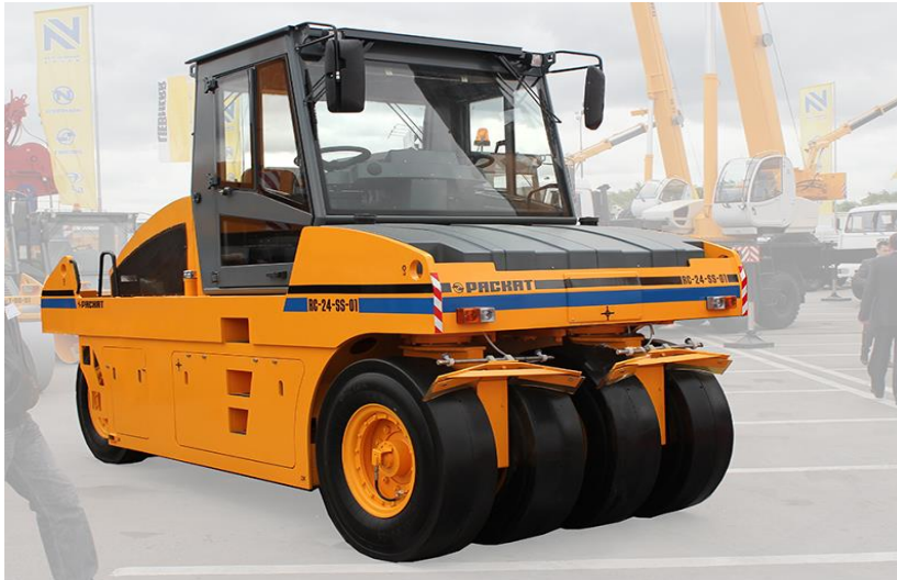
5.1-расм. PASCAT RC24SS русумли пневмошинали статик каток (зичлагич)
