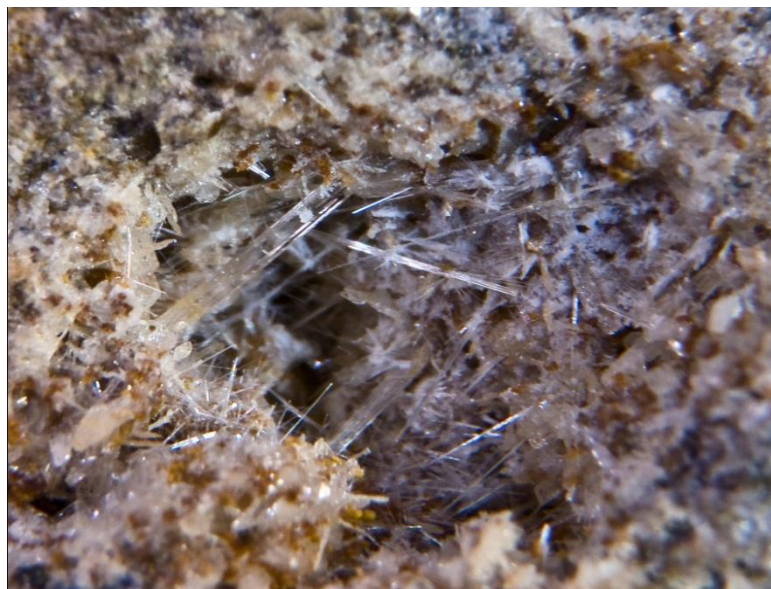
1-расм. Волластонитнинг микронасимон тузилиши (1700 марта катталаштириб олинган).
