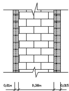
$R_1, R_2, \dots, R_n$  - тўсиқ деворининг, ҳар бир қатламларининг термик қаршиликлари  $\text{м}^2 \cdot \text{К} / \text{Вт}$
