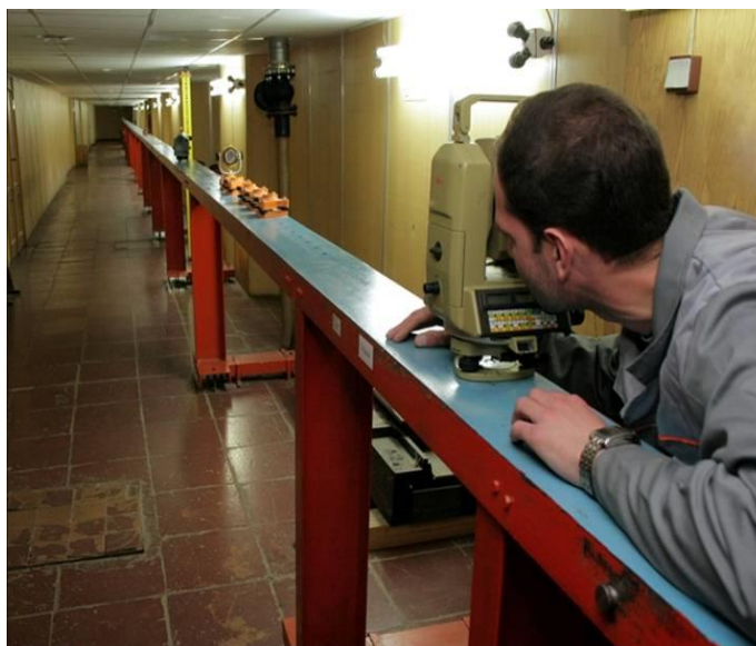
85-расм. Электрон тахеометрни лаборатория шароитда метрологик текширувдан ўтказиш жараёни: а) горизонтал ва вертикал бурчакларни
