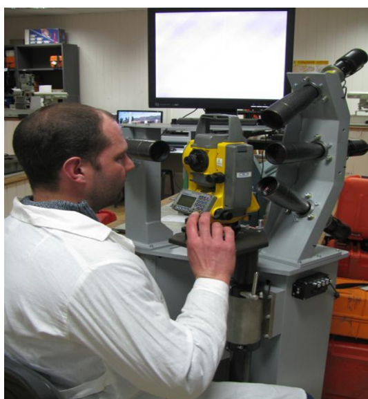
85-расм. Электрон тахеометрни лаборатория шароитда метрологик текширувдан ўтказиш жараёни: а) горизонтал ва вертикал бурчакларни
