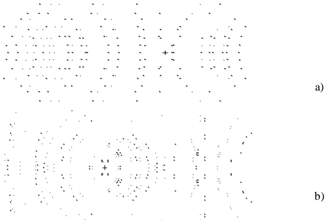
18-súwret. Qorǵasın ortovanadatı Pb_4(VO_4)_2 ferroelastigi kristalınıń joqarı temperaturalı monodomenlik hám tómen temperaturalı polidomenlik fazaları ushın esaplap shıǵılǵan modellik terbeliw rentgenogrammaları.
