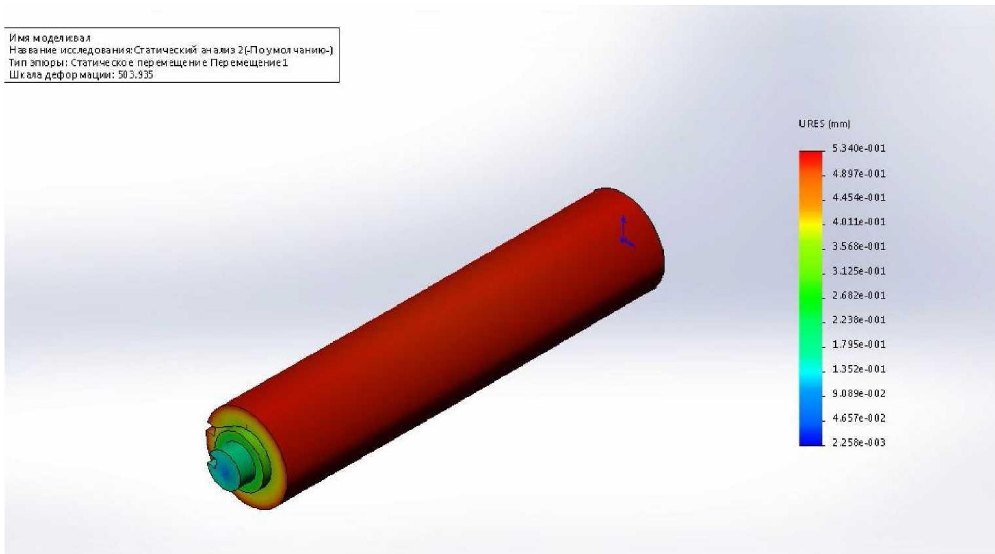
15-Arralı silindr valining quyilgan kuchlar ta'siridagi deformasiyasi
