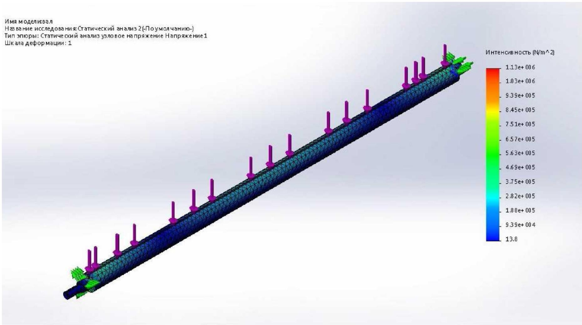
13-rasm. Arrali silindr valining quyilgan kuchlar ta'siridagi kuchlanishi
