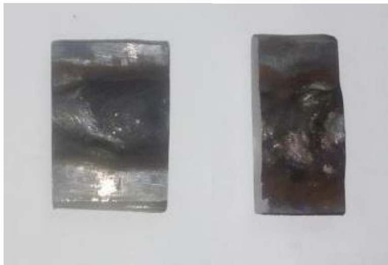
32-rasm. Yeyilishga sinash uchun tayyorlangan namunalar
