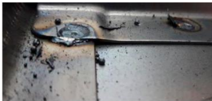
2-расм. Нуқтавий контакт пайвандлаш жараёнида учқун ва металл сочрамалари пайдо бўлиши оқибатида пайвандланган панелнинг ҳолати.
