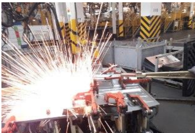
4.1-rasm. Korxonaning payvandlash sexidagi nuqtaviy kontakt payvandlash jarayonida ajralib chiqayotgan metall sachramalariga misol
