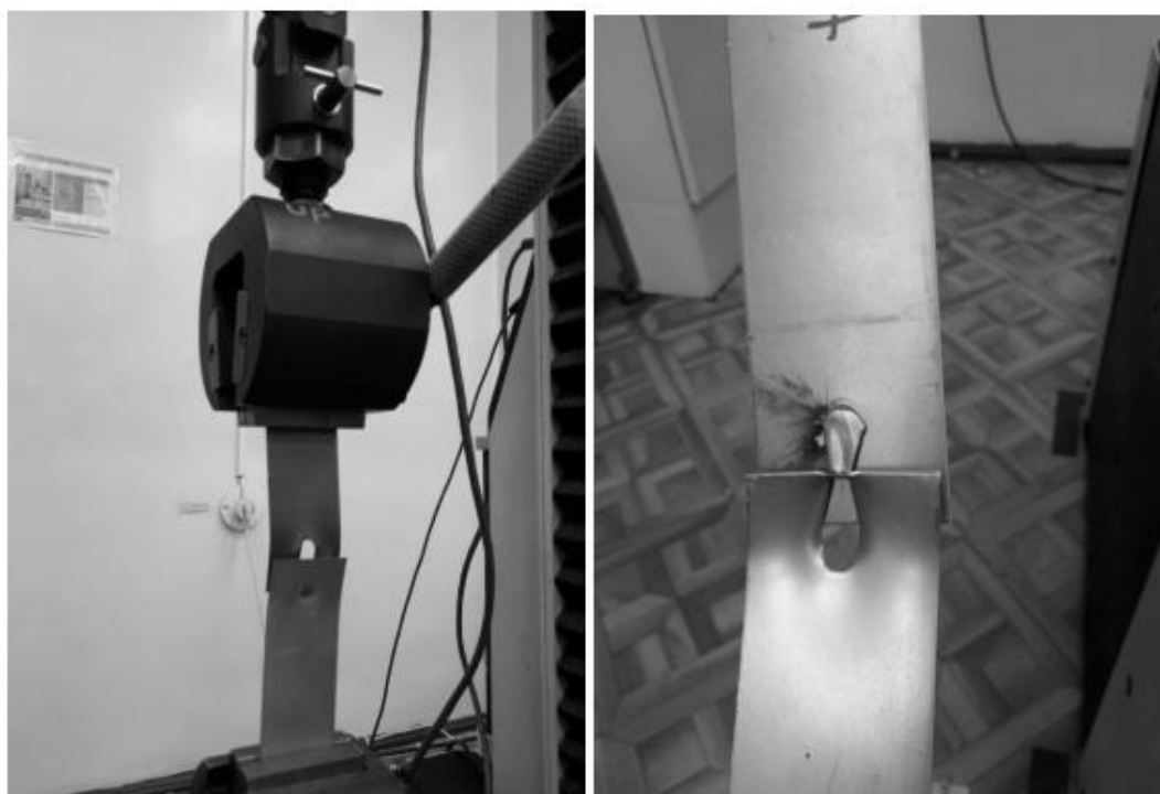
Рисунок 5. Процесс испытания сварных соединений на прочность и вид сварного соединения после разрыва
