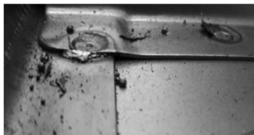
Рисунок 2. Состояние панели после образования выплесков при контактной сварке
