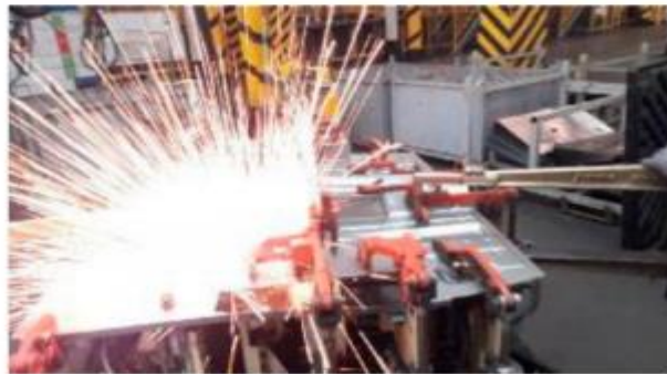
1-расм. Нуқтавий контакт пайвандлаш жараёнида учқу металл сочрамалари пайдо бўлишидан бир лавха.
