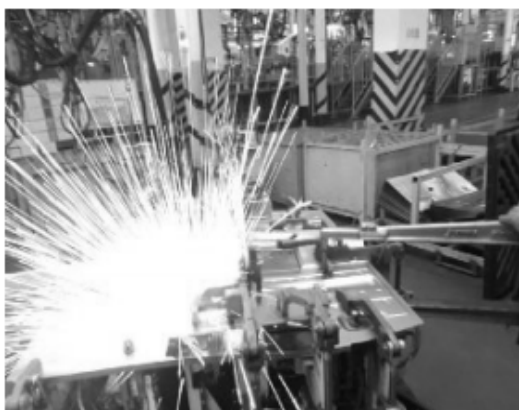
Рисунок 1. Пример образования выплесков в процессе точечной контактной сварки
