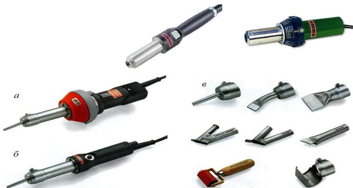
Qizdirilgan gaz bilan payvandlashda qo'llaniladigan turli markadagi gorelkalar va ularning uchliklariga misollar
