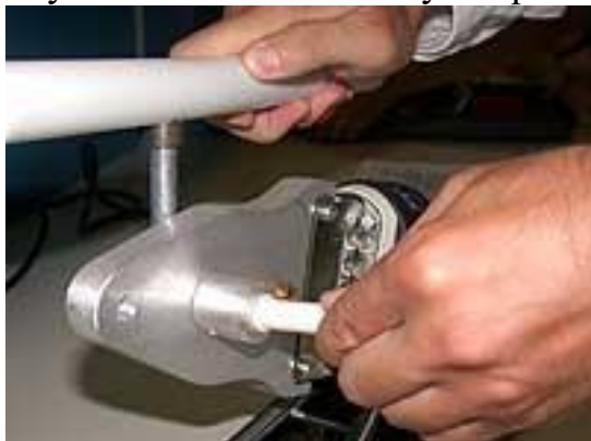
Polipropilen trubalarni bir-biriga kiritib payvandlashga mo'ljallangan payvandlash apparatlari: bir o'lchamli va uch o'lchamli.
