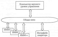
Рис. 3.15. Типовая архитектура распределенной системы управления
