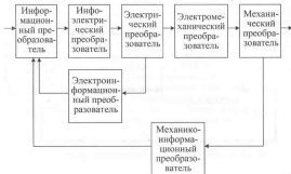
Рис. 2.6. Функциональная модель мехатронного модуля
