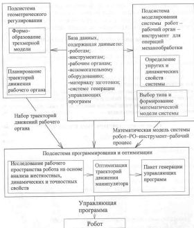
Рис. 4.7. Система автоматизированного программирования движений технологического робота
