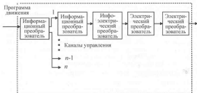
Рис. 2.11. Функциональная модель традиционной системы управления манипулятора "PUMA-560"
