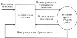
Рис. 2.5. Функциональное представление мехатронной системы
