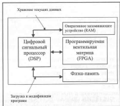
Рис. 1.37. Архитектура контроллера движения фирмы Google Technology
