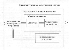
Рис. 1.24. Классификация мехатронных модулей
