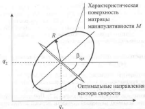
Рис. 5.1. Эллипсоид кинематики мехатронной машины
