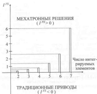
Рис. 2.9. Показатели функционально-структурной интеграции для традиционных приводов и мехатронных решений
