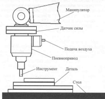
Рис. 4.6. Рабочий орган робота с силомоментным датчиком
