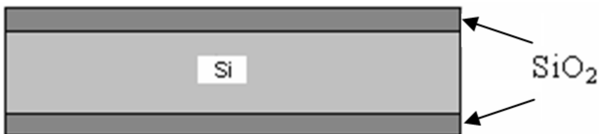
3-rasm. Kremniy plastinasi izolyator qobig'i bilan.
