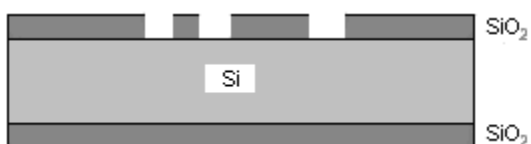
7-rasm. Kremniy plastinasi rel'ef tushirilgan holda
