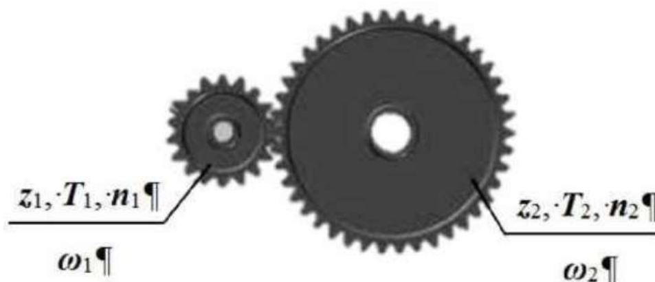
4.1-rasm. [GOST 16530-83, GOST 16531-83] bo`yicha tishli uzatmalar parametrlarini belgilari
