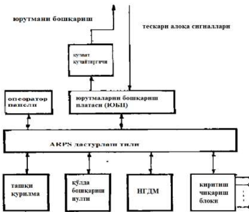
2.5-rasm. Manipulyator boshqaruvining blok sxemasi
