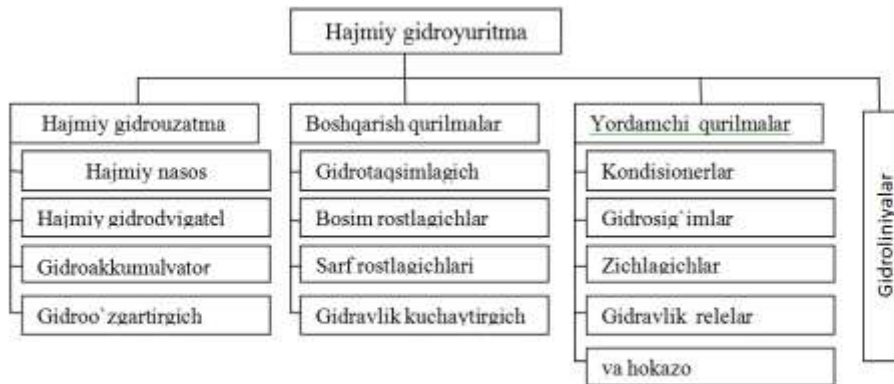
1-rasm. Hajmiy gidroyuritma struktura sxemasi.
