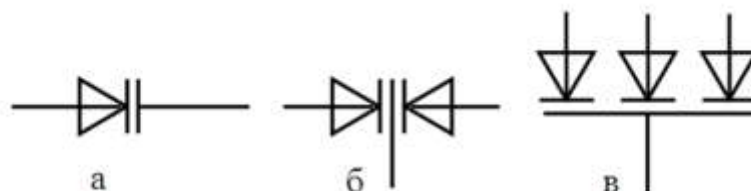
6 – расм. Варикапларнинг шартли белгиланишлари: а – варикап; б – бир катодли икки ва уч варикапли (в) матрица
