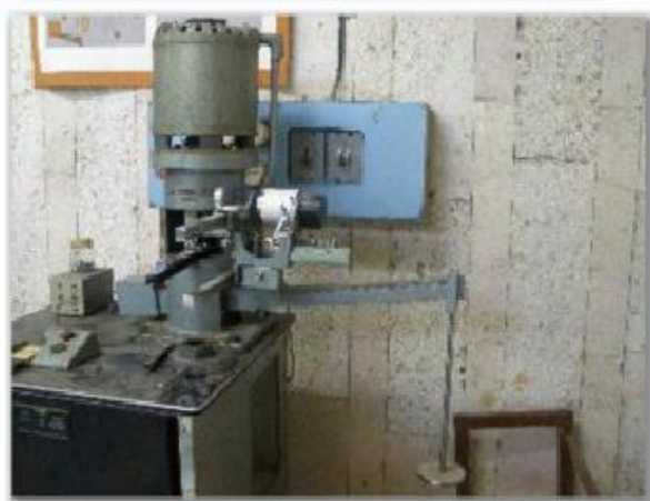
25-rasm. Setti-Shell ishqalanish mashinasining sxemasi va umumiy ko'rinishi.
