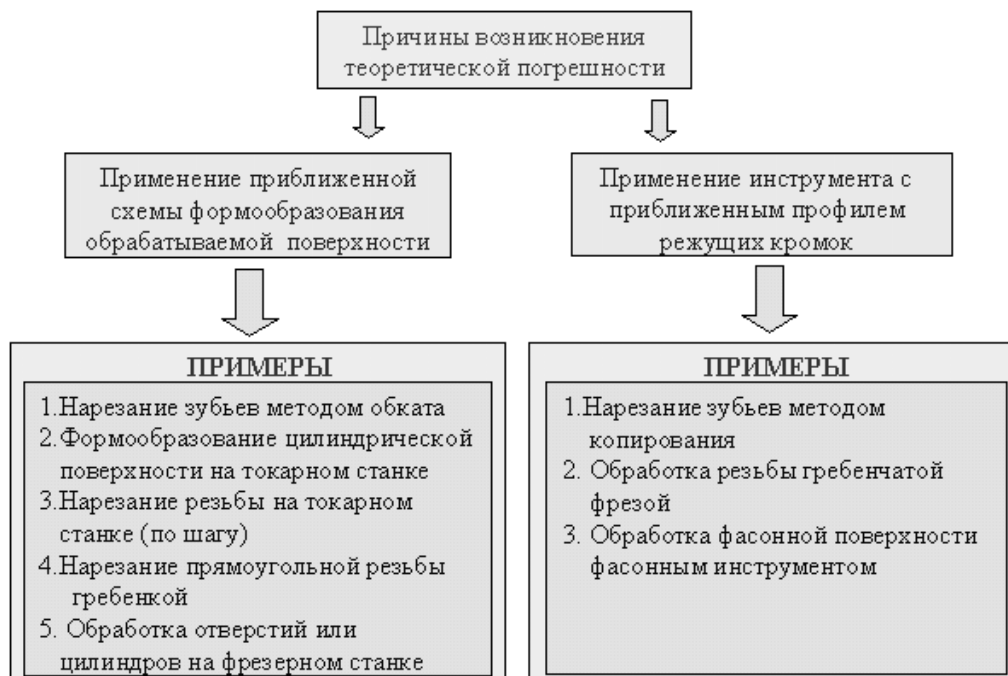
Рисунок 4.10 Примеры образования погрешностей от теоретической схемы обработки
