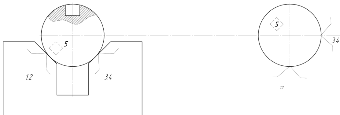
Рисунок 6.7 Схема базирования цилиндра на призме
