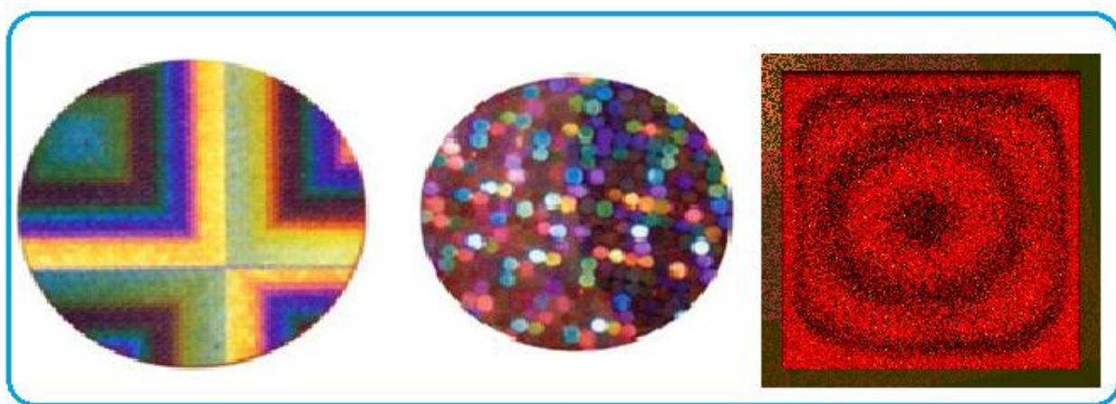
3.17-расм. Деформацияланган жисмнинг голограммаси.
