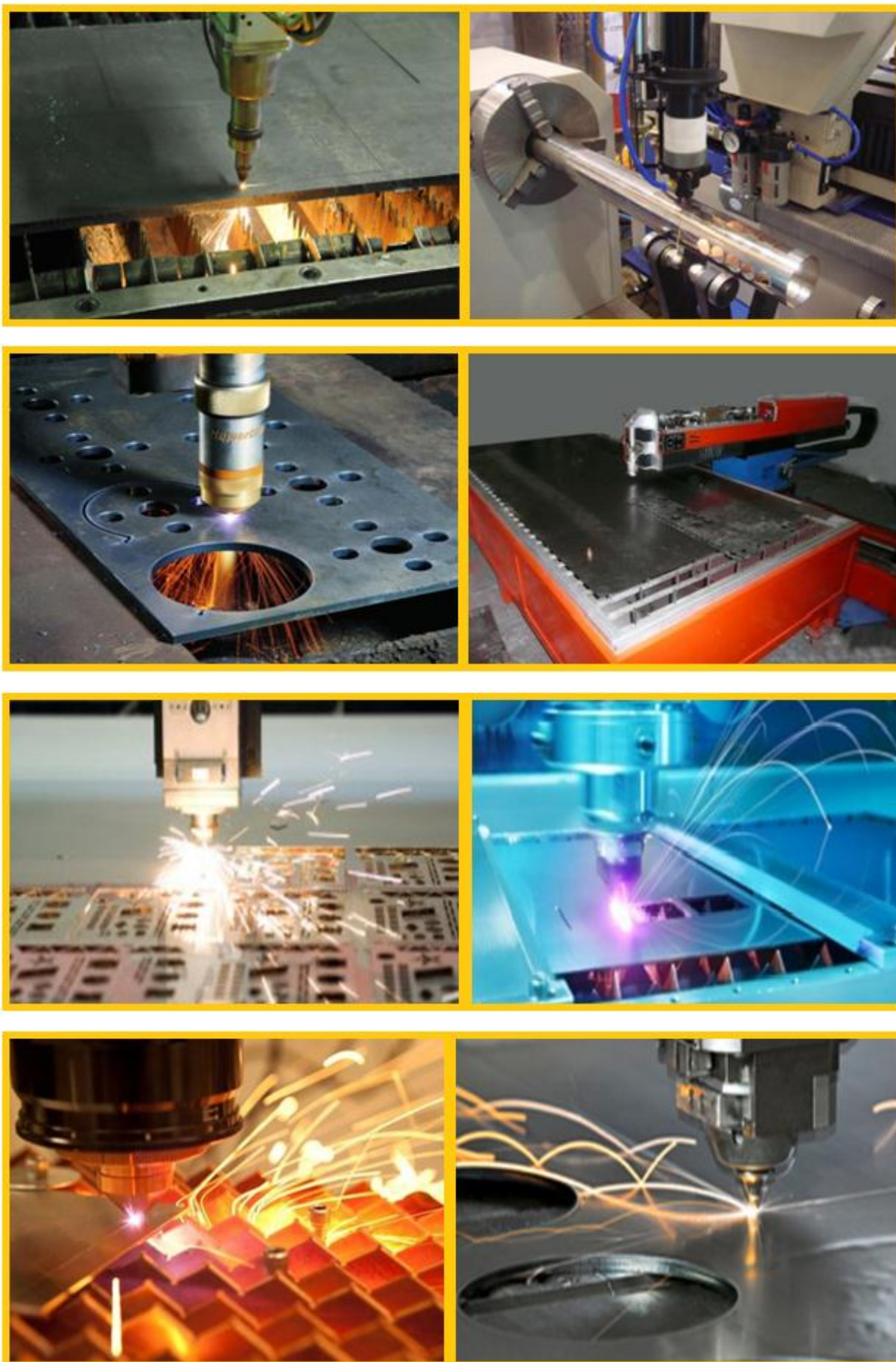
3.28- расм. Металларга лазер нури ёрдамида ишлов бериш.
