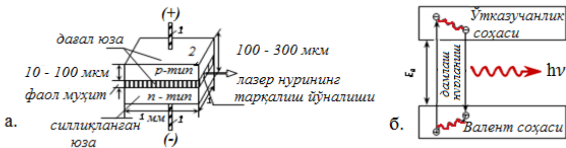
2.17- расм. а) Яримўтказгичли лазернинг тузилиши: 1-электр токи бериладиган симнинг контакти, 2-яримўтказгич кристали; б) Дамлаш.
