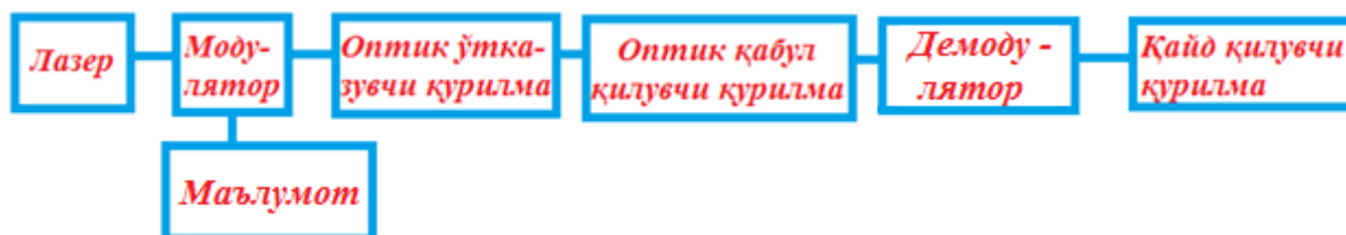
3.1 - расм. Оптик алоқа тизими схемаси.
