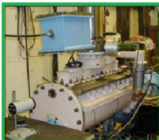
Узлуксиз маромда ишлайдиган CO 2 лазер
