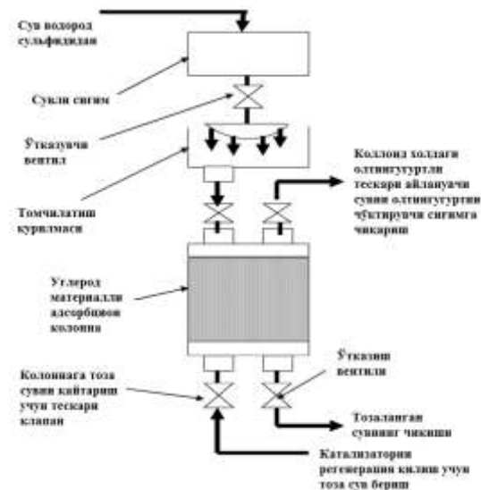
16-расм. Б блокда сувни ВС дан каталитик тозалаш қурилмаси.
