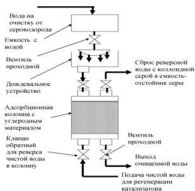
Рис. 16. Устройство каталитической очистки воды от СВ в блоке Б.
