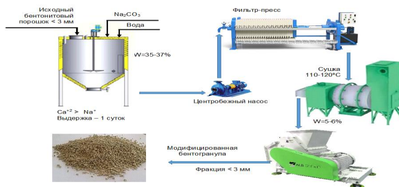
Рис.3. Технологическая схема модифицирования бентонита
