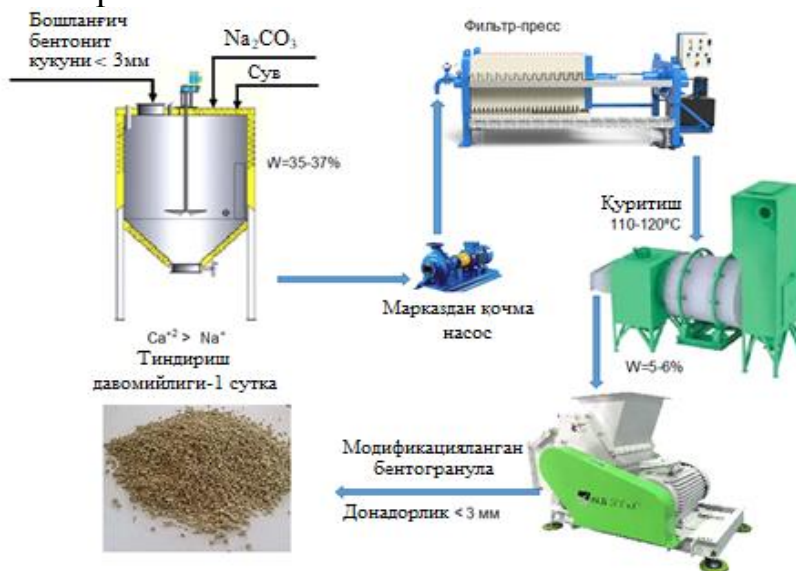
3-расм. Бентонит гилини модификациялашнинг технологик схемаси
