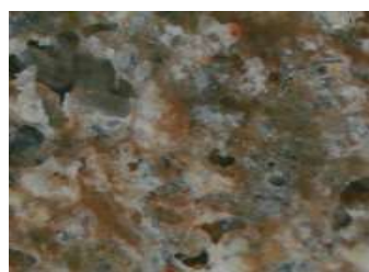
7-расм. КҚ намунасининг электрон микроскопик тасвирлари: а) мустаҳкамловчи композиция кўшилмаганда б) КҚ ларда 4 таркибли композиция кўшилгандаги кўриниши.
