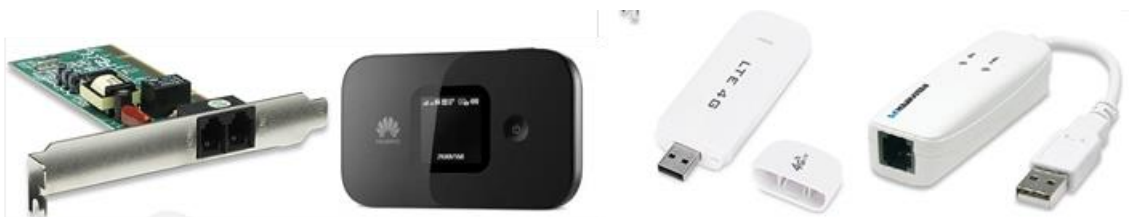
6.2.11-rasm. Kompyuterni global tarmoqqa ulash uchun maxsus qurilmalar
