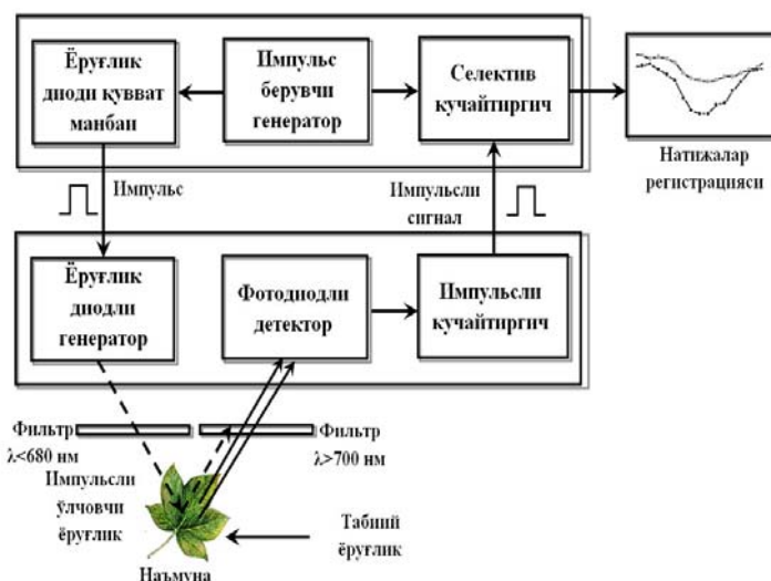
1-расм. Импульс-амплитудали модуляция флуорометрининг ишлаш принципи
