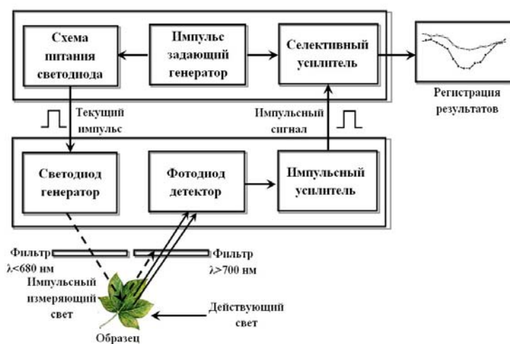
Рис. 1. Схематический вид принципа измерения флуоресценции импульсно-амплитудной модуляции
