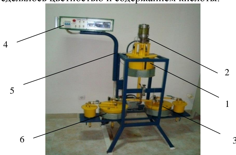
1-смеситель-отстойник, 2-двигатель; 3-емкость; 4- датчик; 5-стойка; 6-спирал.
