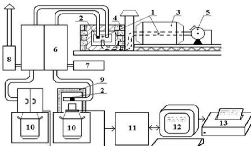
1-  $^{252}\text{Cf}$ -нейтронлар манбаси; 2-намуна; 3- нейтронлар манбаасини саклаш кутуси (контейнери); 4-нурланиш блоки; 5-электромотор; 6-пневмотранспорт тизими; 7-компрессор; 8-фильтр; 9- кўрғошинли уй; 10-суяқ азотли Дьюар идишидаги ярим утказгичли детектор (ЯЎД); 11-аналог-рақамли ўзгартиргич; 12-Pentium-III компьютери ва 13-принтер
