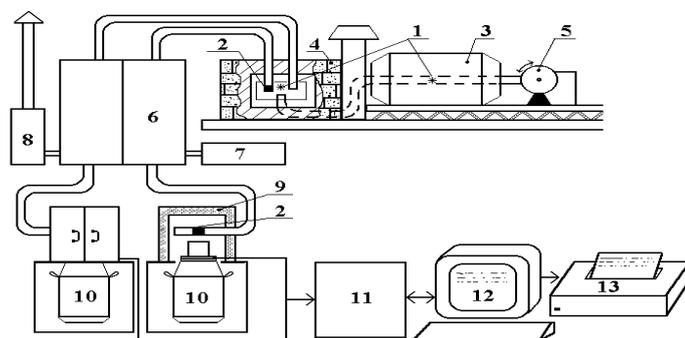
1-источник нейтронов -<sup>252</sup>Cf; 2-проба; 3-контейнер для хранения источника нейтронов; 4-блок облучения; 5-электромотор; 6-пневмотранспортная система; 7-компрессор; 8-фильтр; 9- свинцовый домик; 10-ППД находящийся в сосуде Дьюара с жидким азотом; 11-аналого - цифровой преобразователь; 12-ПК типа Pentium – III и 13 – принтер
