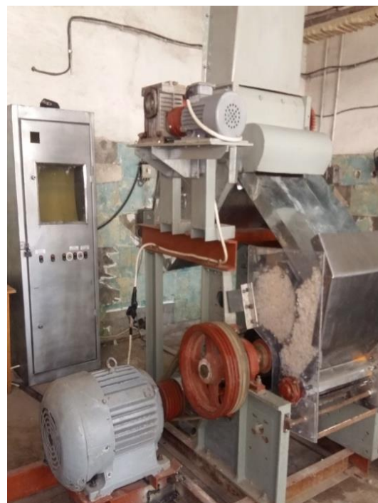
Рис. 11. Пильный джин с двухбарабанным питателем и набрасывающим барабаном
