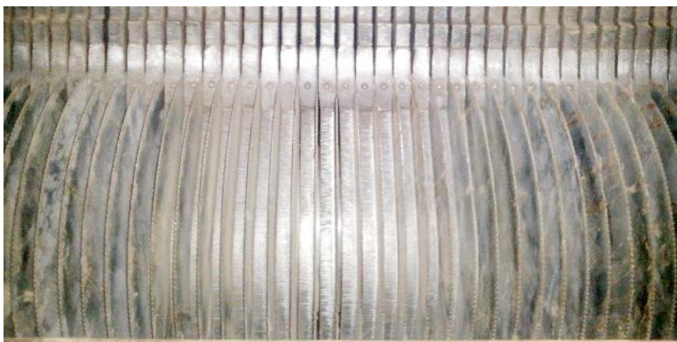
17 - расм. 4ДП – 138 аррали жин ишчи камерасидаги колосникли панжара ва аррали цилиндр.
