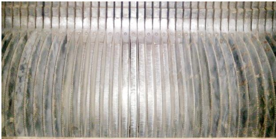
Рис. 17. Пильный цилиндр с колосниковой решеткой в рабочей камере пильного джина 4ДП-138
