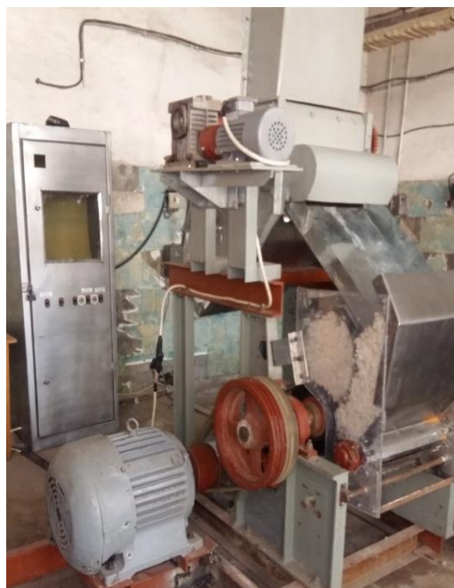
11 - расм. Икки барабанли таъминлагичли ва отиб берувчи барабанли аррали жин.
