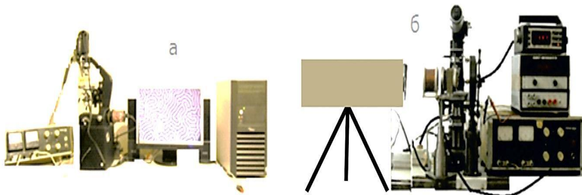
10-расм. Доменларни кузатиш (а) ва магнитооптика калитларни тадқиқ этиш қурилмаси (б).
