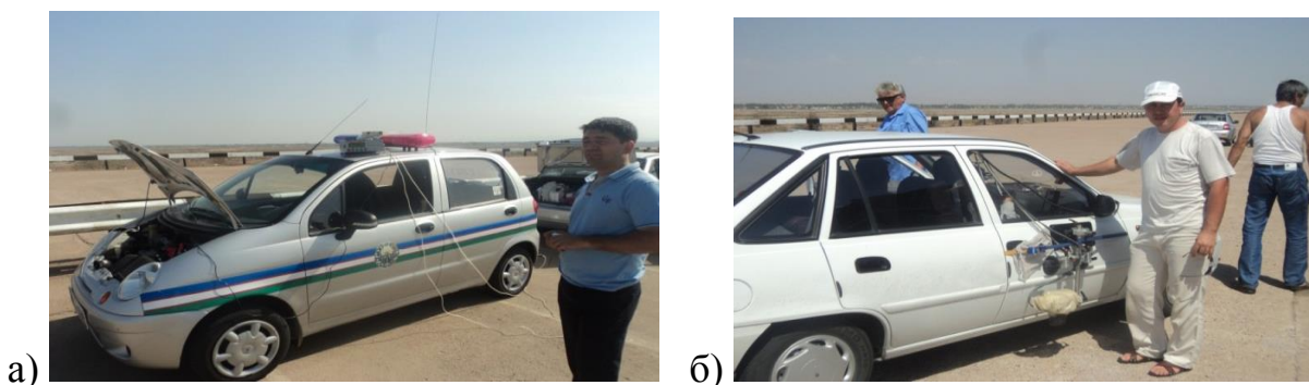
Рис. 3.2. Фрагменты полигонных исследований а) полигонные исследование автомобиля NEXIA, б) определение выхлопного газа автомобиля MATIZ (с помощью газоанализатора).
