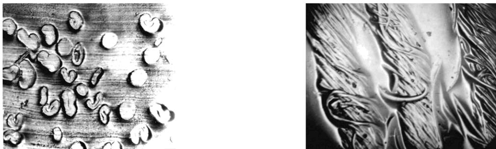
**Рис.9. Особенности строения поперечных сечений элементарных волокон и характер расположения элементарных волокон составляющих пряжу линейной плотности 29 текс**
