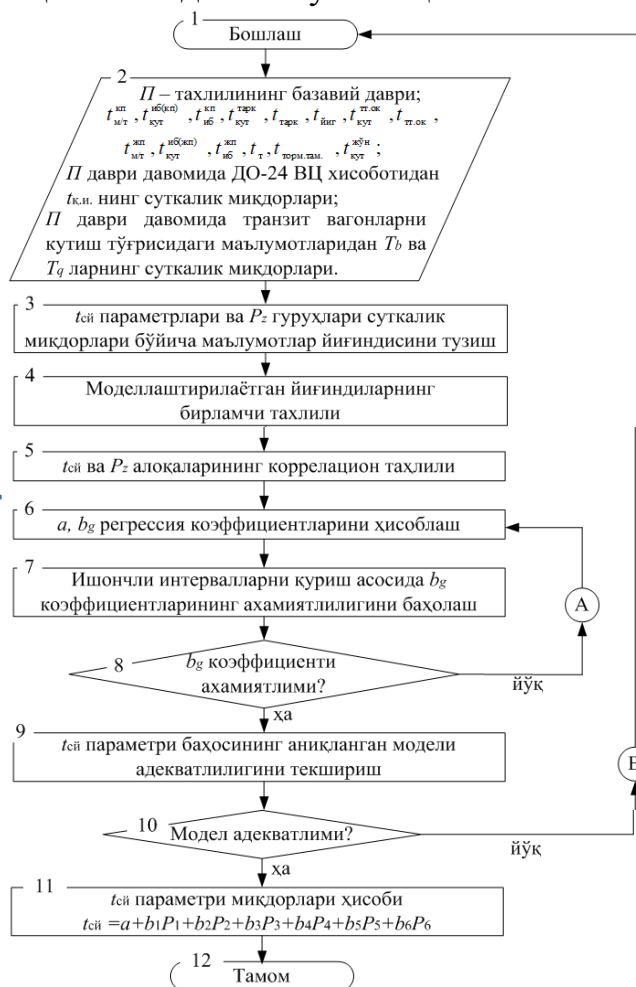
6-расм. Саралаш станцияси ишида t_{сй} параметрини баҳолаш алгоритми блок схемаси: А – йўқотишлар сабаблари гуруҳи P_z йиғиндисида моделлаштиришдан ўчириб ташлаш жараёни, ушбу коэффициент унча сезиларли эмас; В – моделни қайта шакллантириш жараёни
