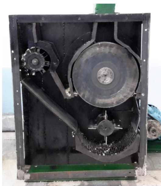
Рис.11. Лабораторная установка линтерной машины
