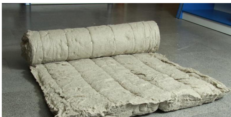
2.13-расм. Базальтли тола асосида иссиқлик изоляцияси
