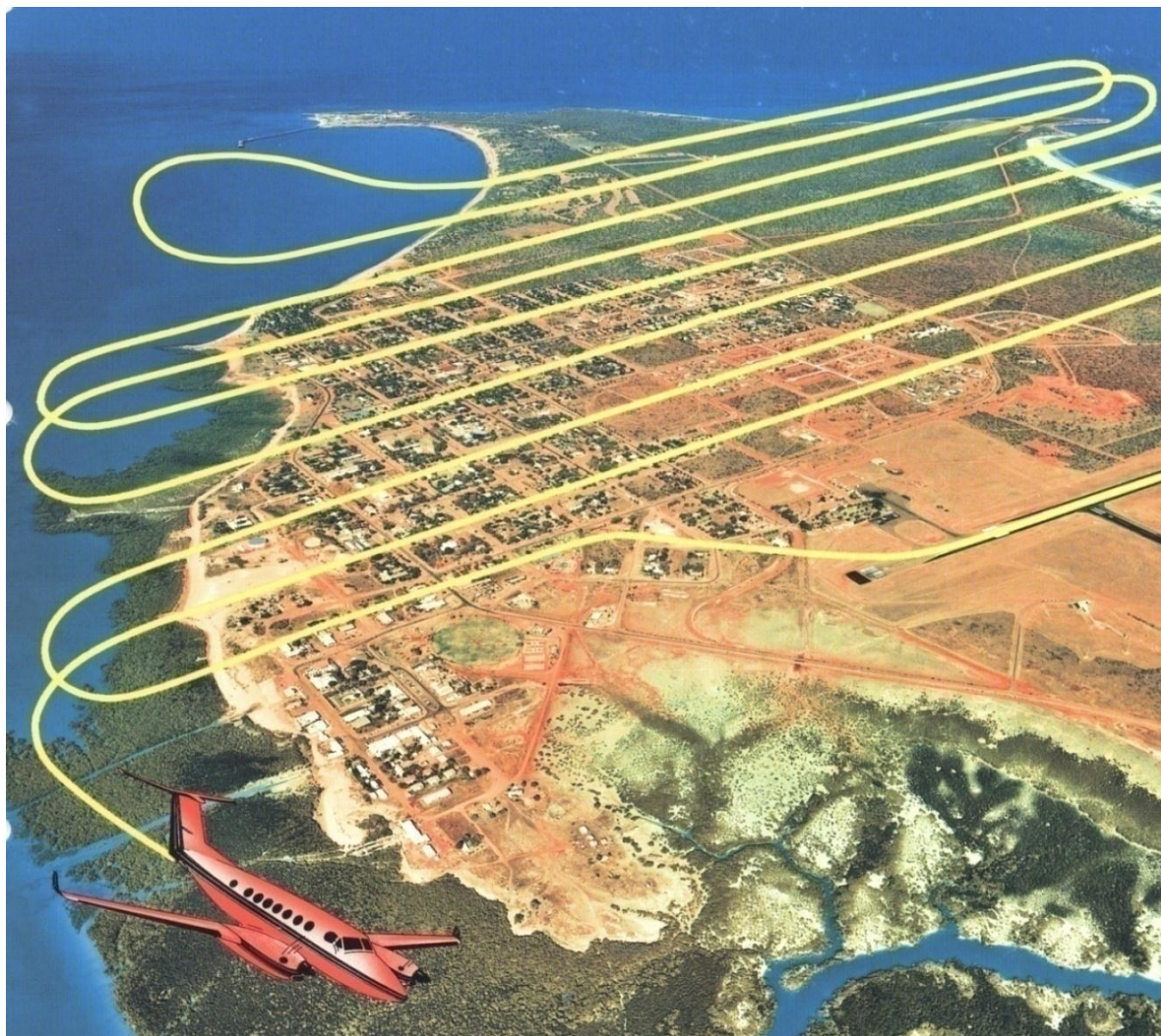
79-шакл. Майдонни самалиёт орқали аэрофотосъёмка қилиш жараёни.
