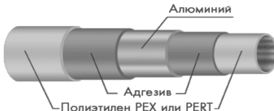
12-расм. Темир пластик қувур тузилишининг қирқими.
