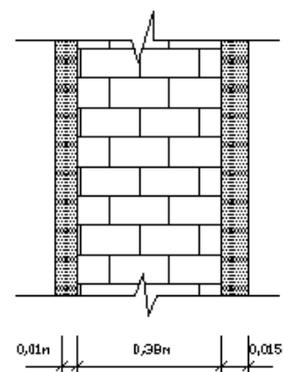
$R_1, R_2, \dots, R_n$ - тўсиқ деворининг, ҳар бир қатламларининг термик қаршилиқлари  $\text{м}^2 \cdot \text{К} / \text{Вт}$
