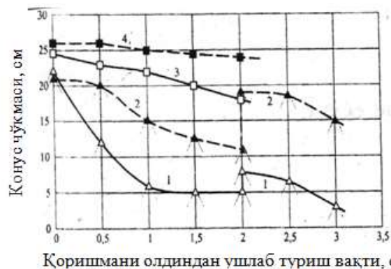
19.11-расм. Керамзитбетонли қоришма ҳаракатчанлигининг вақт бўйича ўзгариш графиклари. Керамзитнинг намлиги ва МК киритиш усуллари: 1, 2- керамзит табиий намликда бўлганида; 3, 4- керамзит сув билан тўйинтирилган бўлганда (тўлиқ чизик-лар МК сув билан аралаштирилиб, штрихли чизиклар эса МК қуруқ холда киритилганда).
