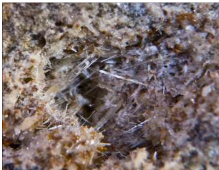
14.5-расм. Волластонитнинг микроинасимон тузилиши (1700 марта катталаштириб олинган).
