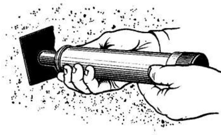
16.10-расм. ПМ-2 асбоби билан бетон юзасини синаш.
