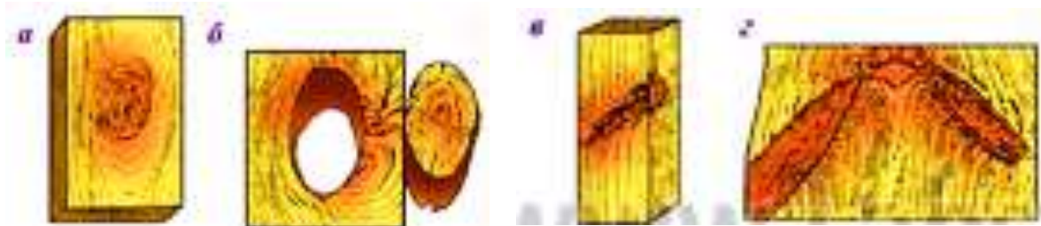
11.6-расм. Ёғочдаги кўзларнинг жойланиши. а-битиб кетган соғлом; б-етилмай қуриб қолган кўзлар; в-тўқима битилган кўзлар; з-тарқалган кўзлар
