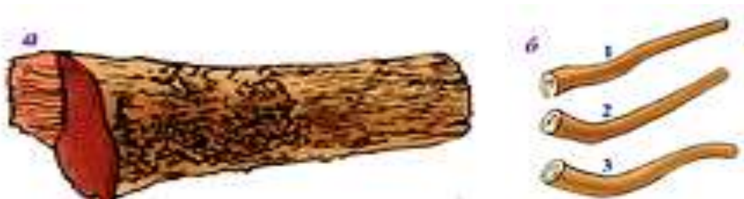
11.9-расм. Дарахт танасининг меъёрий шаклидан четланиши. а- тупсаланишлик; б-эгрилик (1, 2-оддий; 3-мураккаб).
