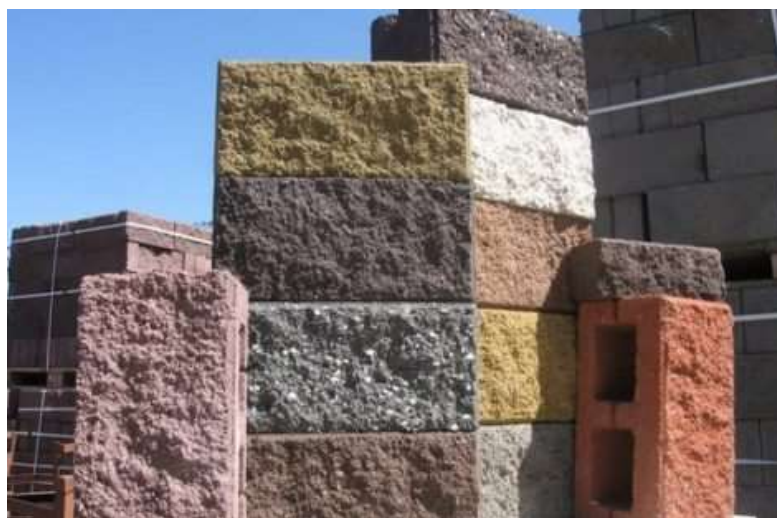
Рис.2. Лицевые блоки с шероховатой поверхностью.
