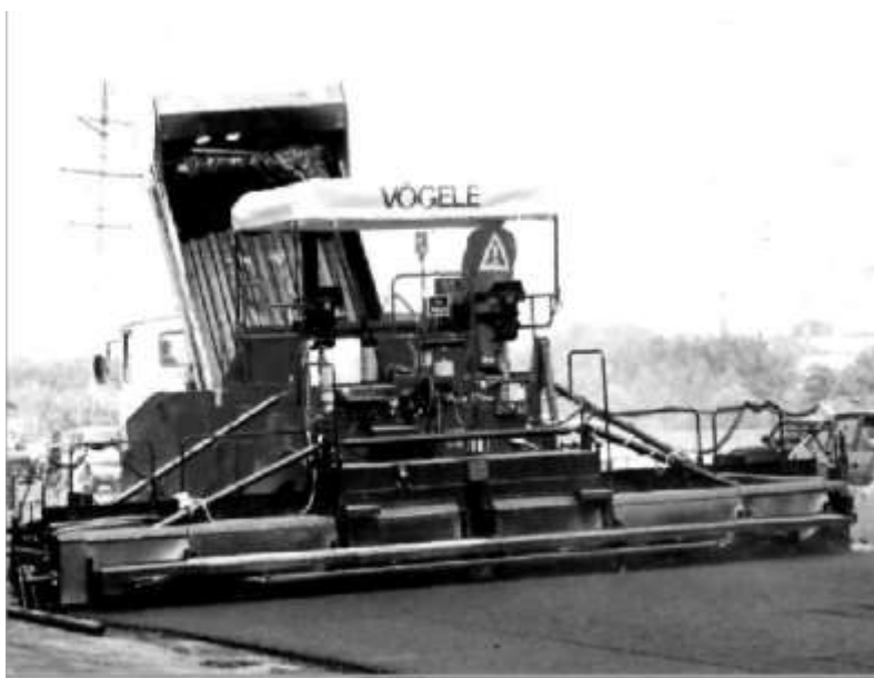
7.11-расм. Асфальтбетон қоришмасини регенерациялаш машинасида қайта ишлаб йўл қопламасига ётқизиш ва зичлаш
