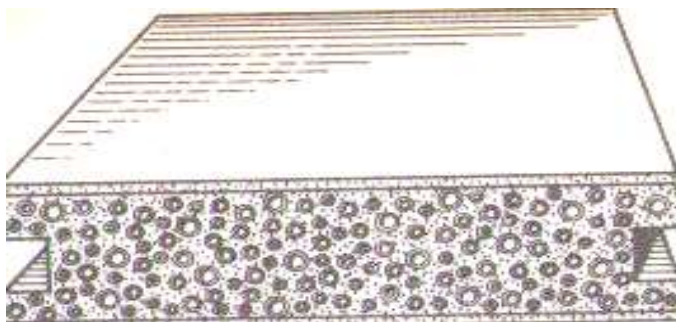
5.22- расм. Қамишбетонли таиқи девор блокнинг конструкцияси.
