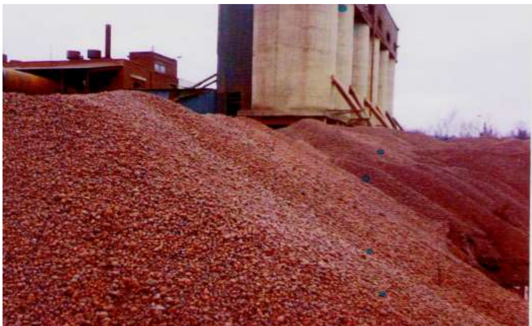
3.3-расм . Доналанган ИЭС шлаклари асосидаги шагал.
