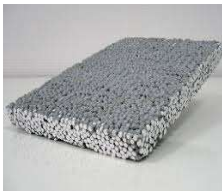
7.6-расм. Полистролбетон (а) ва полистролбетонли иссиқ сақловчи плита (б).
