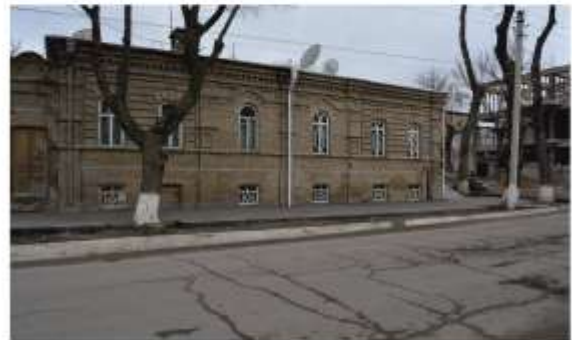
Фасады из обожженного кирпича; кирпич-сырец используется в конструкциях стен по периметру.
