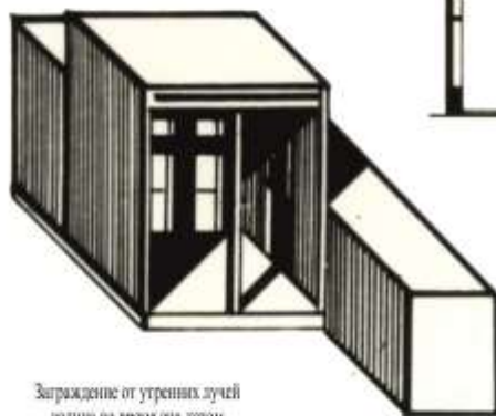
Айван многофункциональный элемент-ветроудалнитель.
