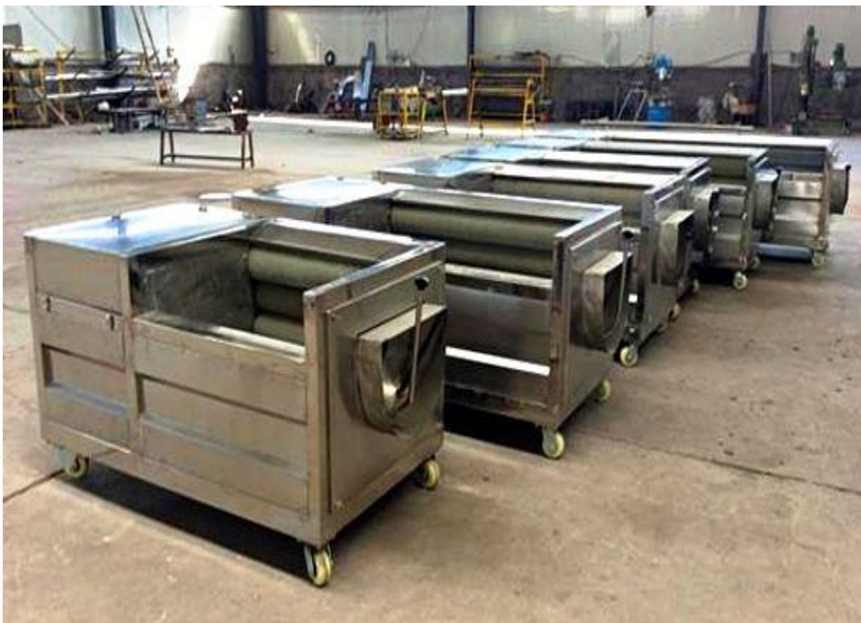
2.2-rasm. 752-01 tipli sabzavotlarni tozalash jihozi.
