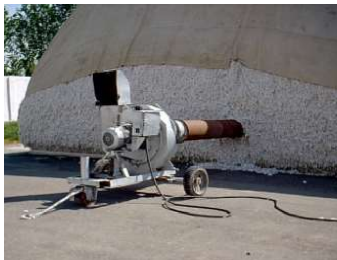
1.1.1-расм. Вентиляторни ғарамга ўрнатиш усули.
