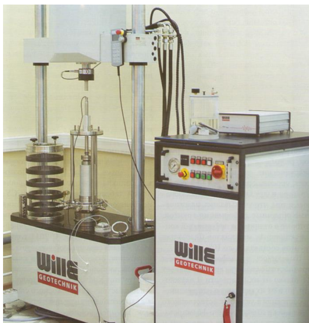
3.27-rasm. Gruntlarni uch o‘qli siqish bilan sinovchi asbob.
