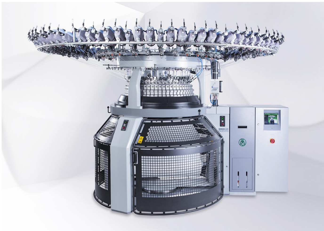
Рисунок 7. Однофонтурная кругловязальная машина Mayer & Cie Basicline S4 - 3.2
