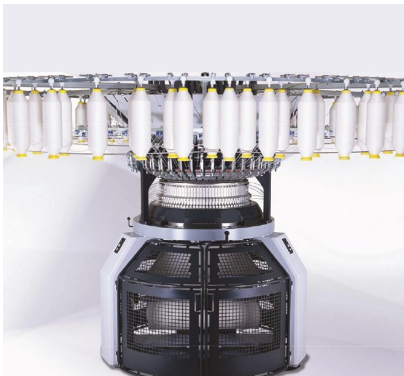
Рисунок 26. Кругловязальная машина Mayer & Cie Spinit 3.0
